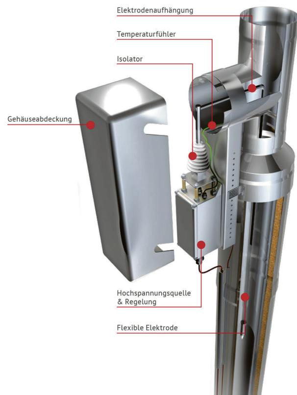
Der BISOAIRSTREAM FEINSTAUBABSCHIEDER zum Nachrüsten wird als eine Einheit von oben in die Schornsteinmündung eingesetzt. Die komplette Technik befindet sich witterungsgeschützt in eine Edelstahlverkleidung – damit ist sie robust und optisch neutral.
