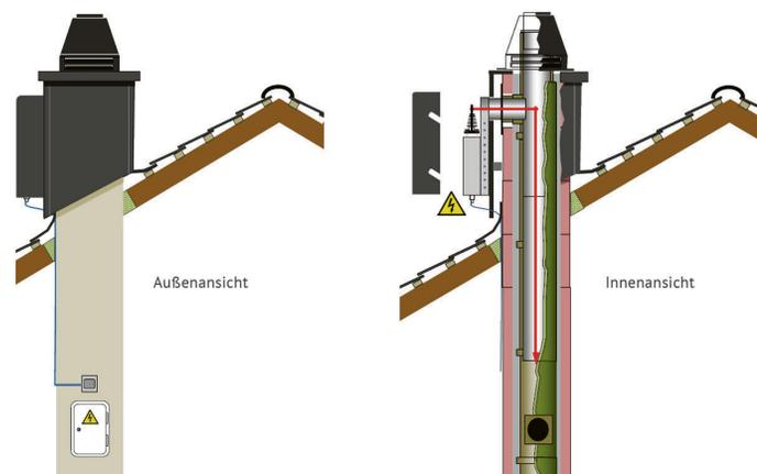
In dem kompletten, zukunftsfähigen Abgassystem BISOAIRSTREAM LAS-F PRO ist der Feinstaubabscheider im Bausatz integriert, wird mit der Schornsteinmündung installiert und erhält zum Schluss eine schicke witterungsbeständige Verkleidung.
